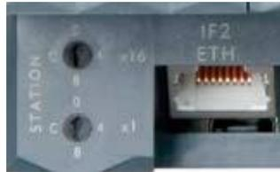
X20 CPU 上的以太网 IF2 接口主要用于安装有 Automation Studio 的计算机与控制器之间通讯连接、下载编程调试。可以使用系统配套的以太网电缆与计算机连接。具体连接的方式、Automation Studio 中必要的操作和配置，请参考 TM210 中控制器对象连接与项目安装的部分。
