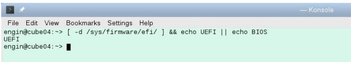
即在使用 **HDClone** 对硬件系统进行备份时，先要确认好 **Bios** 里面设置的 **Boot options** 和实际 **APROL** 安装时选择的启动模式是一致的。**Bios** 里面选择为 **Legacy first**，则软件安装时也是选择的 **Legacy** 的安装启动项；**Bios** 里面选择为 **UEFI first**，则软件安装时也是选择的 **UEFI** 的安装启动项。不要相互矛盾。
