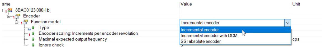
3, Encoder Scaling: Increments per encoder revolution 设置编码器线数, 注意此处应该有四倍频, 比如编码器为 2048 线, 这里设置为 8192。
