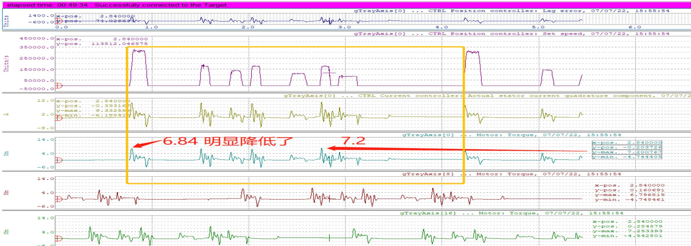
视觉定位过程中，峰值扭矩明显降低；最大扭矩值7.2出现在定位阶段，和HMI设置参数有关系；
