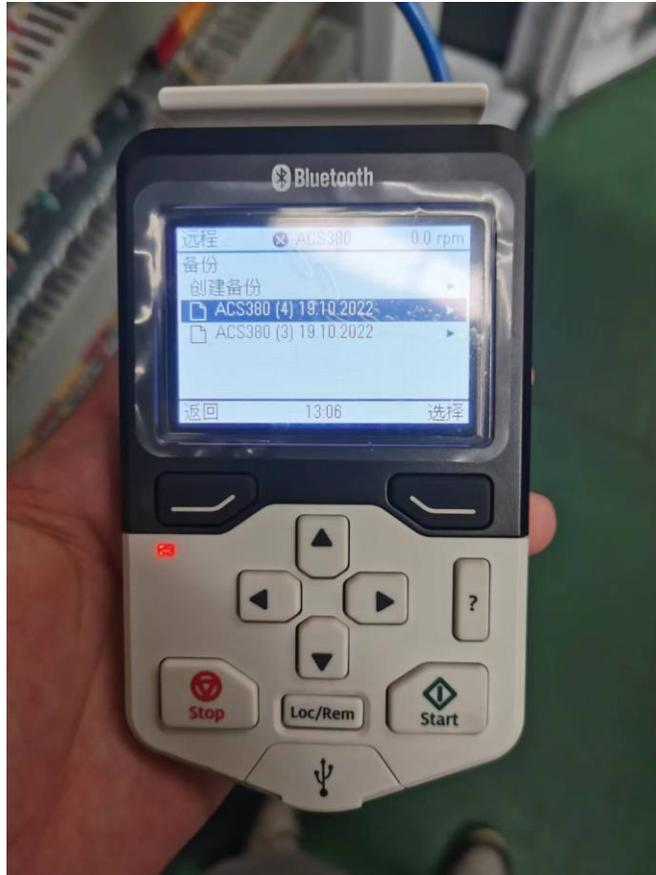
2. 将变频器通过控制盘底部的 Loc/Rem 将驱动器切换至本地控制模式
